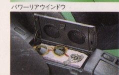
パワーリアウィンドウ カップホルダー付 センターコンソールボックス (小物類は撮影のために用意したものです。)
