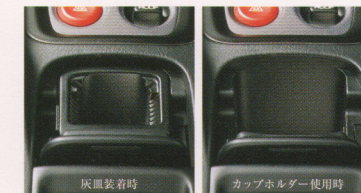
灰皿/カップホルダー センターコンソールのカップホルダーには、脱着式の灰皿をセットできます。
