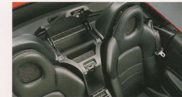
センターコンソールボックス(ロック機構付) センターコンソール後方上部にはアッパーボックス、下部には鍵付きロアボックスを装備。
