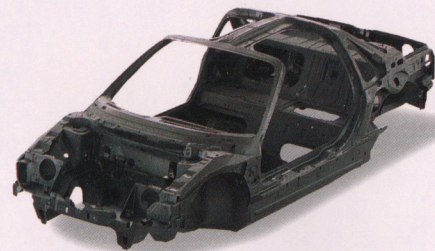
スケルトンモノコックフレーム アンダーボディの要所要所に、横方向に走る強靱な補強メンバーを配置。フロント側下側の計5か所に配した補強ビームとともに横剛性を高め、側方からの衝撃荷重に対応している。
