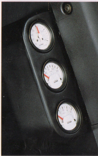
11 メーターセット エンジンの負荷状態を表示する連成計、バッテリーの電圧を表示する電圧計、オイルパン内の油温を確認することでオーバーヒートを未然に防げる油温計をタテ3連に設置したメーターセット。AZ-1のメーター類とマッチする白地に黒文字のデザイン。 ¥57,000(取付費込) ※カップホルダーとの同時装着はできません。
