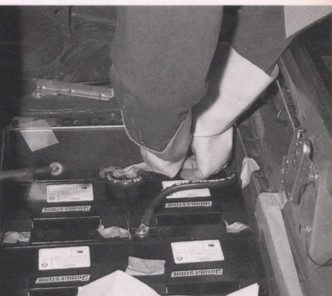
絶縁ゴム手袋をして結線する(第五回)
