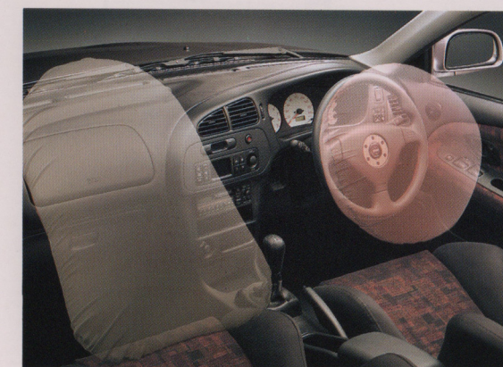
運転席 & 助手席SRSエアバッグシステム (オプション装着車)
