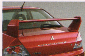
迎角調整式(4段階)大型リヤスポイラー (ハイマウントストップランプは室内装着)
