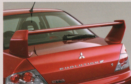
迎角調整式(4段階)大型リヤスポイラー (メーカーオプション:ハイマウントストップランプは室内装着)
