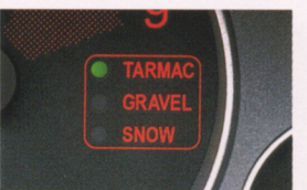
ACDインジケータ TARMAC: 乾いた舗装路面 GRAVEL: ぬれた路面、未舗装路面 SNOW: 雪道
