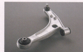
フロントアルミロアアーム 後ろ側ブッシュにゴム付ピロボールを採用し、ストローク感を向上。
