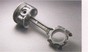
ピストン&コンロッド VIIIではトルク増強にともないピストンには高強度アルミ材を、コンロッドには高強度鍛造鋼を採用し耐久性を向上。
