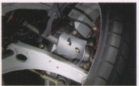
フロントブレーキ冷却導風板 冷却効果をさらに高める、導風板を設定。 (ディーラーオプション)
