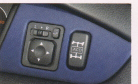
ACDモード切替スイッチ 路面状況にあわせ最適化した3つのオートモードから選択できる。
