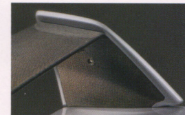
フルカーボン製大型リヤスポイラー 従来のABS樹脂以上の軽量化とアルミ以上の高強度・高剛性化を実現。
