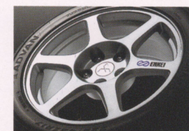
新開発 ENKEI社製 17インチ軽量アルミホイール 鍛造ながらリム部のみを鍛造に近い金属組織とし、軽さと高剛性を両立した。
