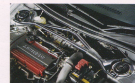
フロントストラットタワーバー 中央結合部のボディ側取付部をリインフォースメントで補強。
