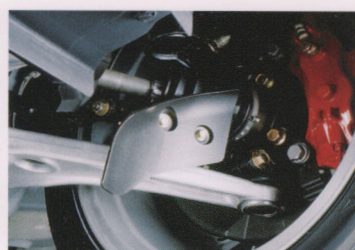
ブレーキ冷却導風板
