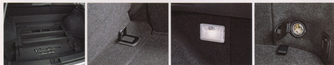
ラゲッジフロアボックス (中央×1, 左右×2) ラゲッジフック (×4) ラゲッジルームランプ (減光機構付) アクセサリーソケット [DC12V] (ラゲッジルーム)
