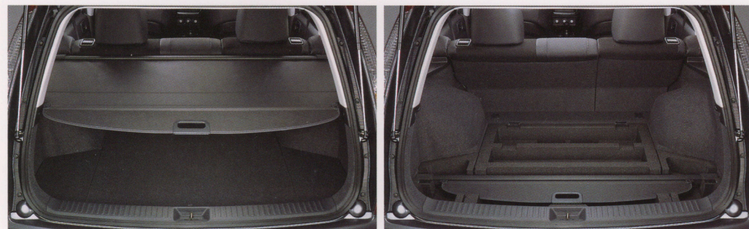
使いやすさと、収納しやすさに工夫がある。スライド式トノカバー (リヤシートリクライニング対応) ワンタッチで取り付け位置を後方に移動できるため、リヤシートをリクライニングさせた際にも使用可能。使用しない時はトノカバーを取り外して、ラゲッジフロアボックス内にぴったり収納できる。
