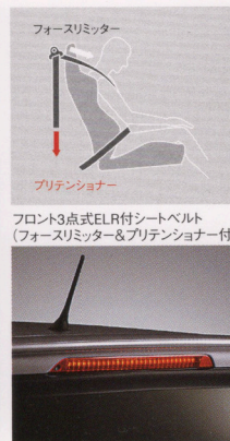
フロント3点式ELR付シートベルト (フォースリミッター&プリテンショナー付)
