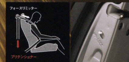
フォースリミッター&プリテンショナー付チャイルドプロテクションフロント3点ELRシートベルト
