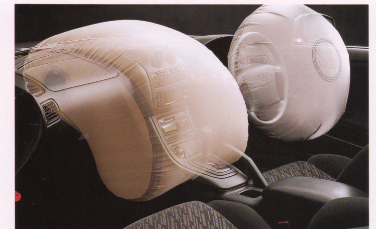
運転席・助手席SRSエアバッグシステム(ABSとメーカーセットオプション/写真のオーディオ+電動アンテナはメーカーオプション)
