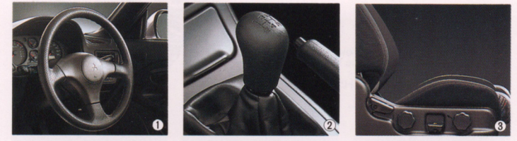
①ディンプル加工付き3本スポークウレタンステアリングホイール ②5速マニュアルトランスミッション ③前後独立調節式ハイトアジャスター(運転席)
