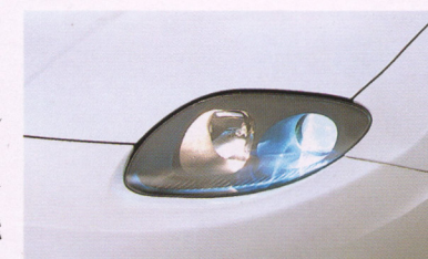
ディスチャージヘッドランプ ●Photo: GPバージョンR
