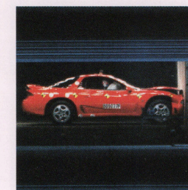
高剛性ボディ ボディの安全構造を徹底的に追求。高い剛性と衝撃吸収性をそなえたボディを実現しています。またボディの設計には最新のコンピュータシミュレーションを採用。(写真は試験用車両)
