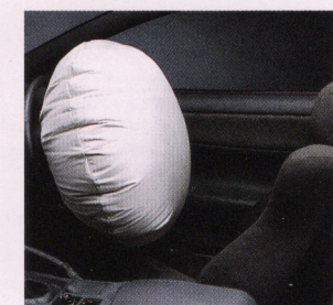
SRSエアバッグシステム 車両前方からの衝突時に、設定レベル以上の衝撃を感知するとエアバッグシステムが作動。ドライバーの上半身を保護します。シートベルトの補助装置として搭載されているものです。
