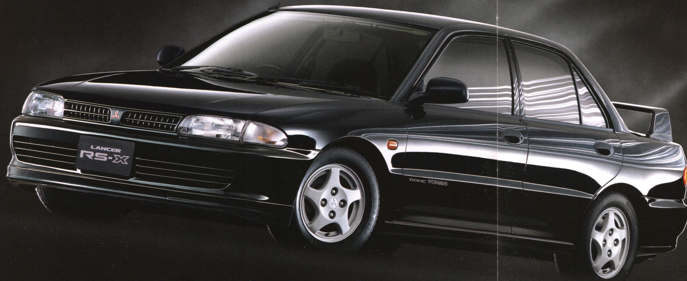
●大型リヤスポイラー(LED式ハイマウントストップランプ内蔵)
