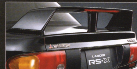
●大型リヤスポイラー(LED式ハイマウントストップランプ内蔵)
