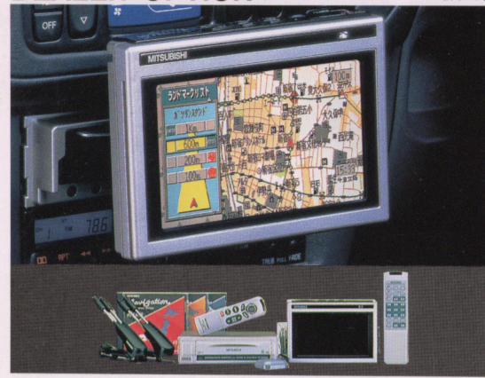
●TVモニター&ハイブリッドナビゲーションシステム GPS+自立航法(ジャイロ+車速センサー)のマップマッチングによる高精度ナビシステム。(画面はメモリ合成です)
