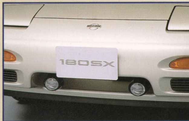
① プロジェクターフォグランプ(ハロゲン55W白(写真)/黄)各 ¥28,500* ABG01/ABG02 スポーティなフォルム。十二分な光量が、夜間や霧中の安全視界を確保します。
