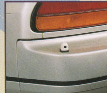
⑰ リヤコーナーセンサー(左側用:ブラック/ホワイト(写真)/シルバー) ¥30,000* ABG07/08/09 超音波で障害物を感知してアラームでドライバーに知らせます。他に左右セットも用意しております。
