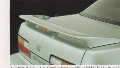
▲リヤスポイラー(ハイマウントストップランプ付) [Sパッケージ]
