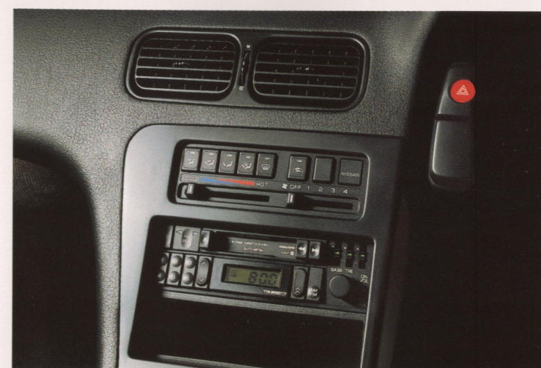
▲〈AM/FM電子チューナー&一体型カセットデッキ(ドルビー対応&メタル対応)〉(K's, Q's)
