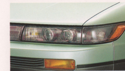
▲プロジェクターヘッドランプ(フォグランプ組込み) [Sパッケージ]
