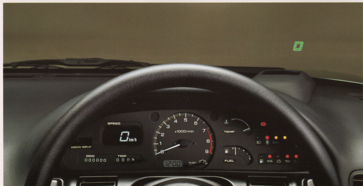
▲〈フロントウィンドウディスプレイ〉写真は機能説明のためメーターを点灯したもので、実際の運転状態時のものとは異なります。フロントウィンドウの車速表示部分はガラス層の一部で、着色加工やフィルム貼りではありません。
