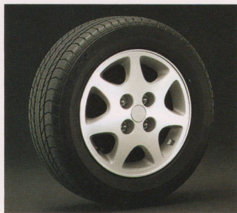
●205/60R15 89Hラジアルタイヤ & 15×6JJアルミロードホイール (シルバーポリッシュ)
