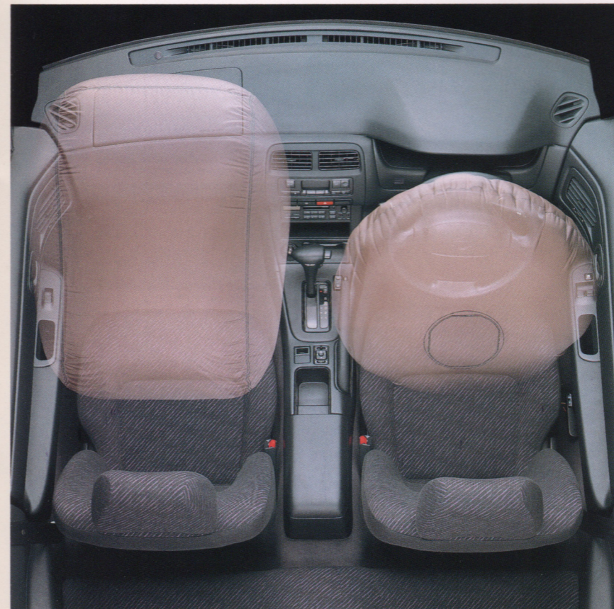
(注)SRSエアバッグシステムは、次のような場合には作動しません。・前面衝突でも、衝撃が小さい時。・横方向や後方からの衝突、あるいは横転、転覆した時。・一度エアバッグが作動した後の衝突。
