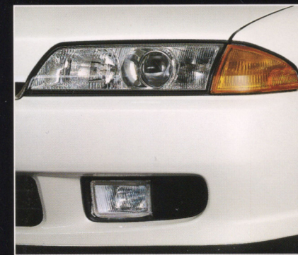
●プロジェクターヘッドランプ& バンパー組込みフォグランプ
