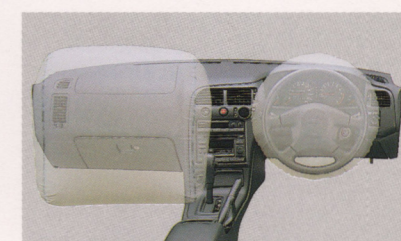
運転席・助手席SRSエアバッグシステム (エアバッグは撮影のため膨らませた状態を再現したものです)
