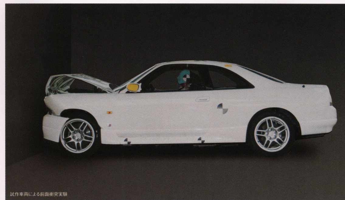
試作車両による前面衝突実験
