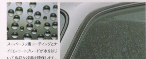
スーパーフッ素コーティングとイオンコートブレードが水をはじいて良好な視界を確保します。フロントガラスに採用。(ディーラーオプション)
