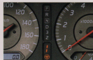
●デュアルマチックシフトポジションインジケータ (M-ATx)
