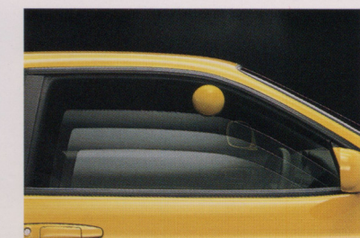
●パワーウィンドウ (運転席はワンタッチ、防水タイプ、キーオフ後作動、換気防止機構付)
