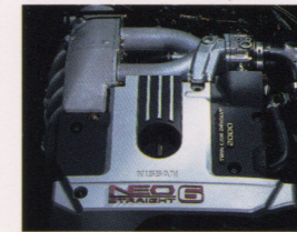
●RB20DE (NEO ストレート6) <リーンバーン>
