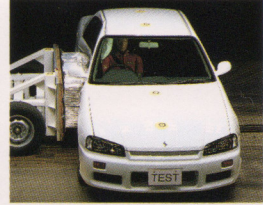
●試作車両による側面衝突実験
