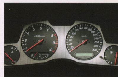
フルスケール300km/hまで刻み込んだスピードメーター。タコメーターは3000rpmでビッチが変わる2段表示式を採用している。
