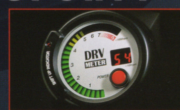
24 ドライビングメーター (シフトアップインジケーター機能付) 2ドア車用 / 4ドア車用 各 ¥34,200 ※ 5UG60/5UG61 エンジン回転数を任意 (200rpm刻み) に設定し、設定した回転を越えると赤いインジケーターランプでシフトアップタイミングを知らせる視認性の高いメーターです。 注) 車両のタコメーターとドライブインジケーターの回転数が若干ずれることがあります。また、取付位置は運転席側のピラー部となります。
