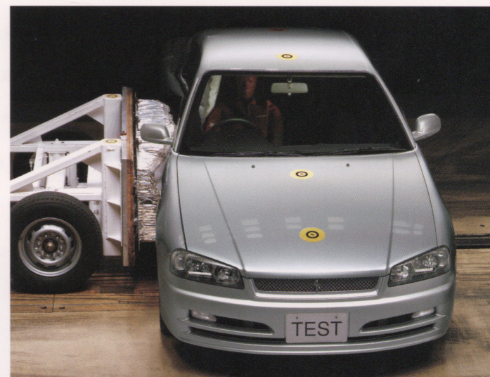
試作車両による側面衝突実験
