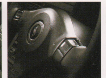
デュアルマチックM-ATx (ステアリングシフトスイッチ)
