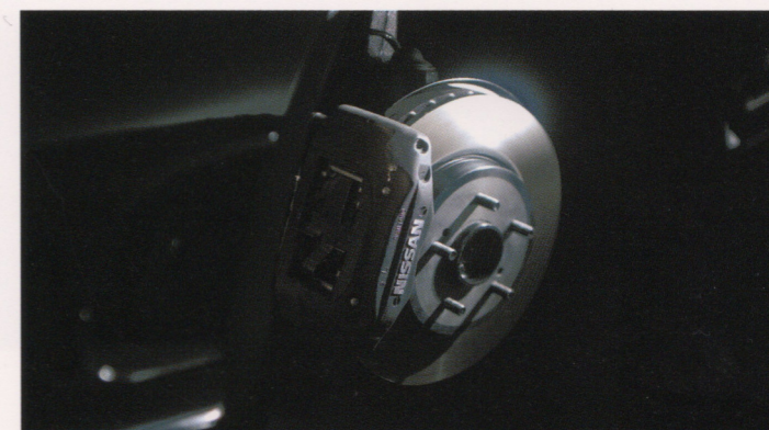
フロントアルミキャリパー対向ピストンベンチレーテッドディスクブレーキ
