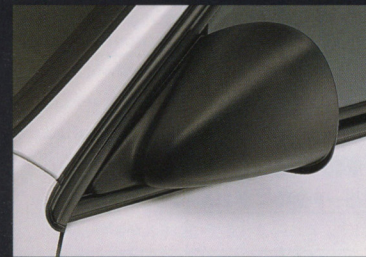
●砲弾型ドアミラー (typeRA STi, typeRA) ※砲弾型ドアミラーは、標準ドアミラーに比べミラー面積が小さく曲率が異なるので、見え方も変わります。
