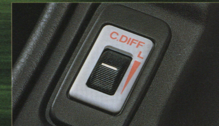
ドライバーズコントロールセンターデフ方式4WDダイヤル部
