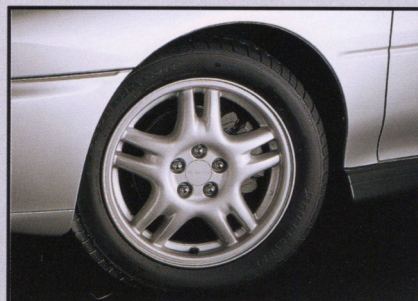
アルミホイール&ハイグリップタイヤ 16×6½JJのアルミホイールは、ワイドタイヤに対応して、剛性確保、軽量化を両立した5本スポークタイプ。タイヤにはグリップ力と耐久性、走行安定性を高い次元で両立したブリヂストン・エクスペディア205/50 R16ラジアルを採用。
