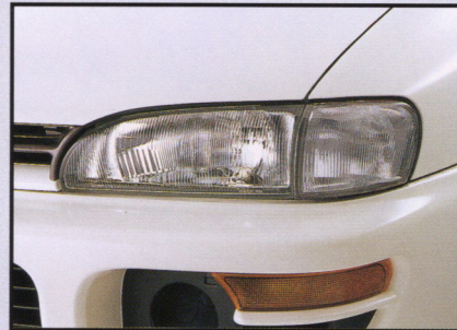
ハイワットageバルブヘッドライト<WRXtypeRA> WRXtypeRAはヘッドライトに、Hiビーム100w、Loビーム80wの強化バルブを採用。ナイトステージでも確かな視界を確保した。
