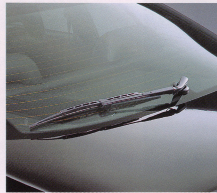
⑤開けっ式リヤワイパー&ウォッシャー/タイマー付熱線プリントリヤデフォグラー
