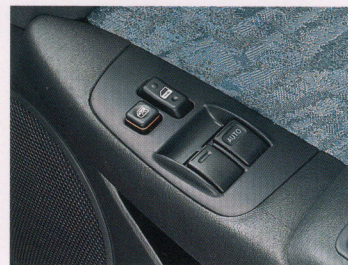
パワーウィンドウ(運転席ワンタッチ式・挟み込み防止機能付) & 電気式ドアロック(全車に標準)
