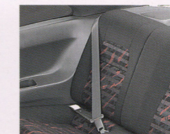
後席ELR付3点式シートベルト(チャイルドシート固定機構付)
