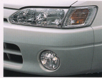
マルチフレクター4灯ヘッドランプ(全車に標準) & マルチフレクターフロントフォグランプ(V仕様を除く BZ-R、BZ-Gに標準、XZ、FZに販売店装着オプション)
