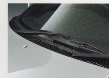
⑦ フィン一体タイプワイパーブレード
